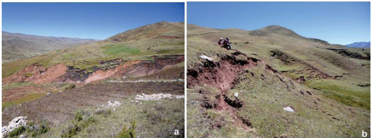
Foto 4: a) Desplazamientos consecutivos del terreno de la parte alta de la ladera con presencia de grietas transversales. b) Presencia de saltos en la parte alta de la corona del deslizamiento-flujo de Santiago Pampa.
