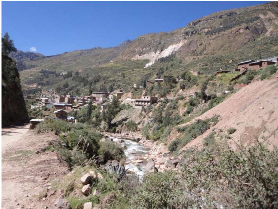
Foto 6: Derrumbes en el sector Yanahuanca, el poblado se encuentra en un depósito antiguo de un derrumbe, con reactivaciones en forma de derrumbes en el pie, margen derecha del río Yanahuanca.
