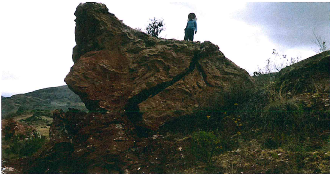
Foto 27: Bloque levantado por el movimiento del deslizamiento, con una longitud máxima de 8 m.
