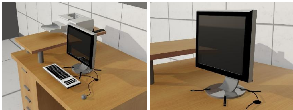
Figura 48. Monitor fijado con correas al mueble de escritorio y evitar su caídas ante movimientos sísmicos.
