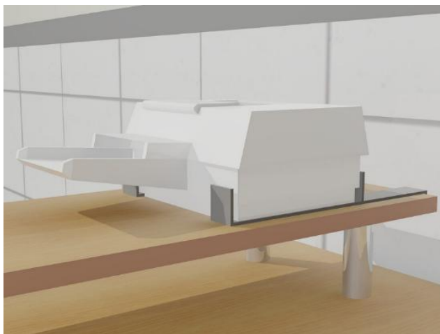
Figura 49. Equipos como impresoras deben estar sujetos a asegurados para evitar su desplazamiento ante movimientos sísmicos.
