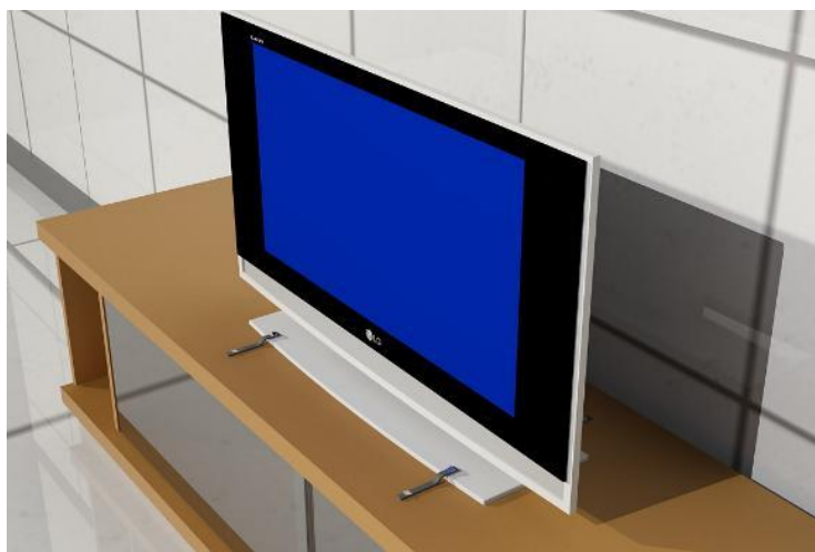
Figura 53. Formas de asegurar equipos electrónicos, mediante seguros de correas.
