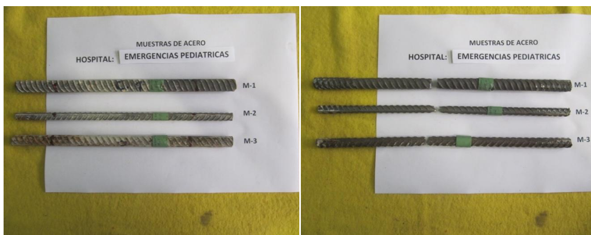
Figura 20. Muestras de acero, antes y después del ensayo de tracción.
