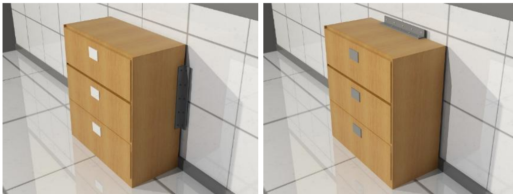
Figura 50. Archivadores deben estar asegurados y evitar caídas que obstruyan salidas o corredores de evacuación. .
