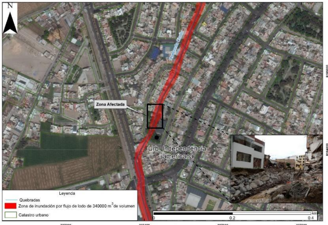
Figura 25. Simulación del huaico del 25 de febrero en la quebrada Chullo.
