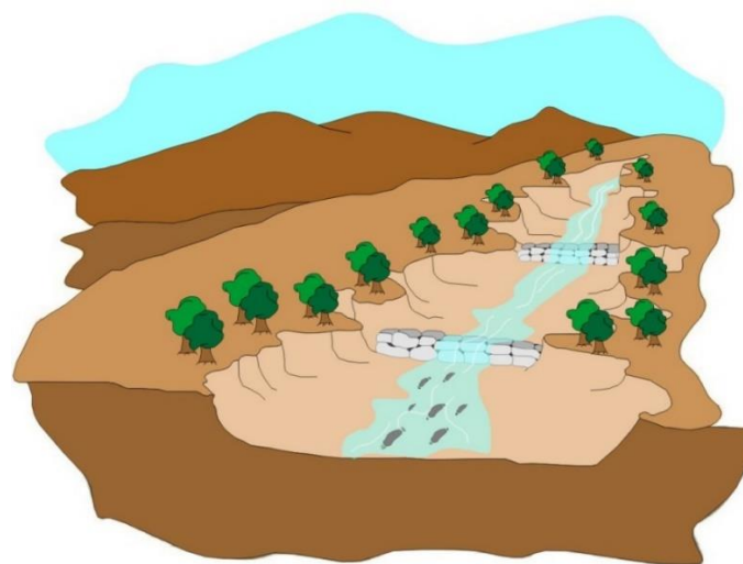
Construcción de presas transversales en cauces de quebradas, y propiciar el crecimiento de bosques ribereños.
