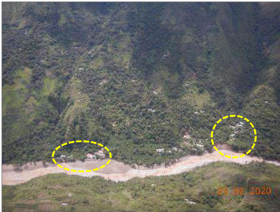
Figura 12. El sector Paltaychayoc, emplazado en la margen derecha, viene siendo afectado por la dinámica erosiva del aluvión.
