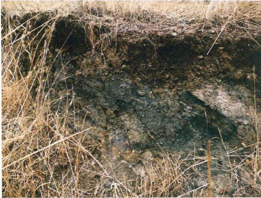
Fotografía 2: Vista del suelo arcillo-limoso con grava resultado de la alteración de arcillitas negras de la Formación Carhuaz.
