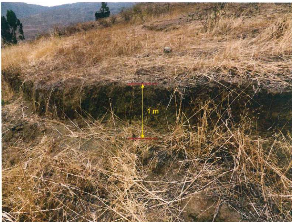
Figura 14: Vista con dirección al este donde se puede observar el salto principal de 1 m del deslizamiento D3.
