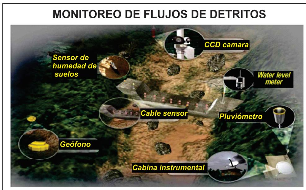
Figura 9.21 Sensores utilizados para el monitoreo de flujos de detritos (Fotografía tomada de Soil and Water Conservation Bureau SWCB-Taiwan por Vilchez, 2010).
