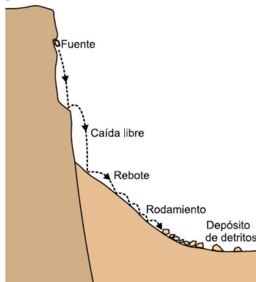
Figura 11. Esquema de la caída de rocas según Varnes.
