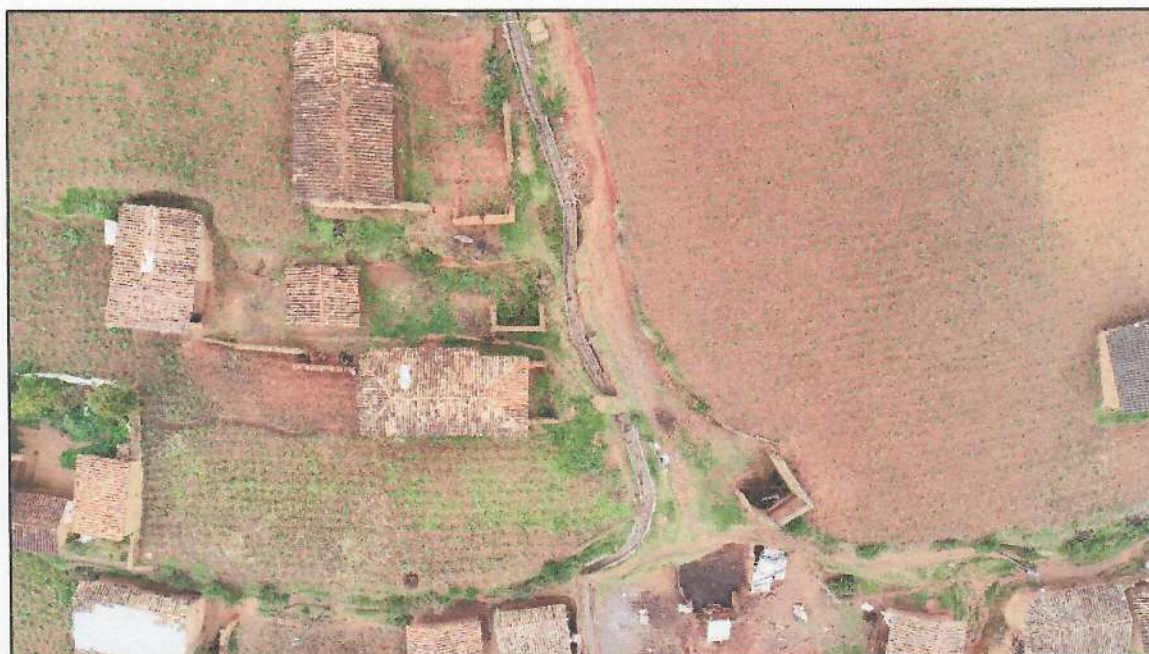
Imagen 10: Fotografía aérea Drone, Vista del Canal Provisional construido por los Pobladores para reducir el Riesgo. (CP. Carampa-Pazos-Tayacaja-Huancavelica). Fuente: Equipo Técnico GRD.
