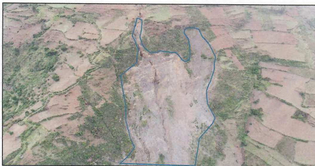
Imagen 02: Fotografía aérea Drone, Vista panorámico de la Erosión de Suelos causada por el agua de la quebrada (Riachuelo), observándose las Rocas del Grupo Cabanillas de la zona de Estudio (CP. Carampa-Pazos-Tayacaja-Huancavelica). Fuente: Equipo Técnico GRD.
