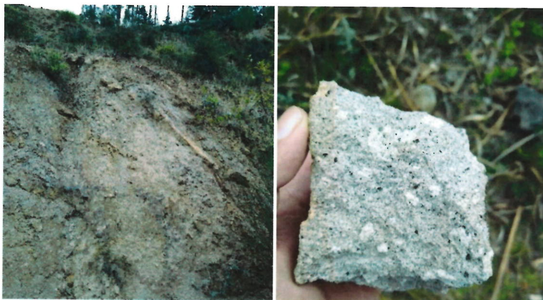
Fotografía 3. Macizo rocoso de la formación Inca muy disturbado (izquierda), y muestra de mano de una toba del volcánico Rumiorco (derecha)
