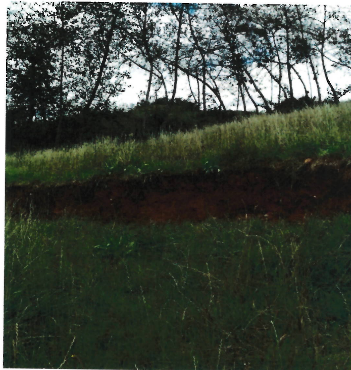
Fotografía 6. Vista tomada desde el escarpe principal con 1.50 m de profundidad y una abertura de 30 cm.
