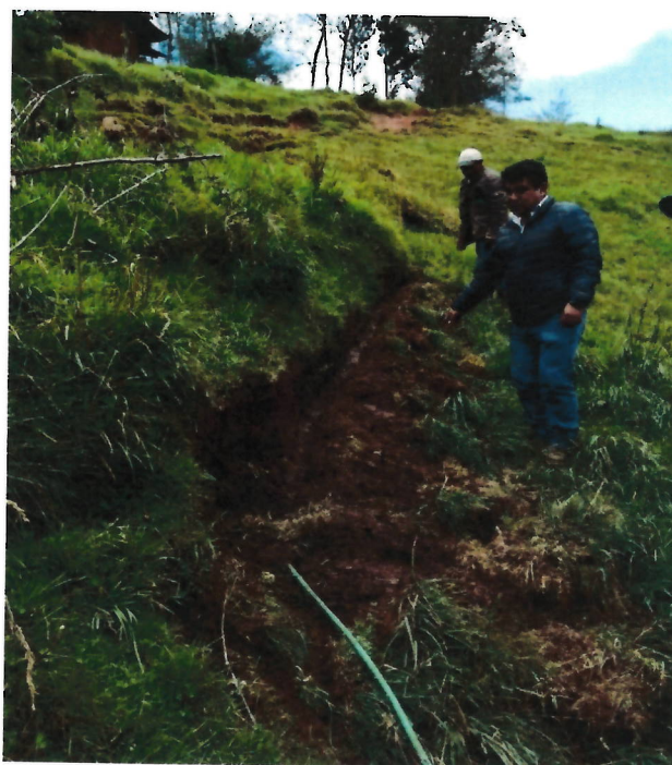
Fotografía 9. Presencia de agua en los terrenos, debido a la infiltración generada por el canal de regadío
