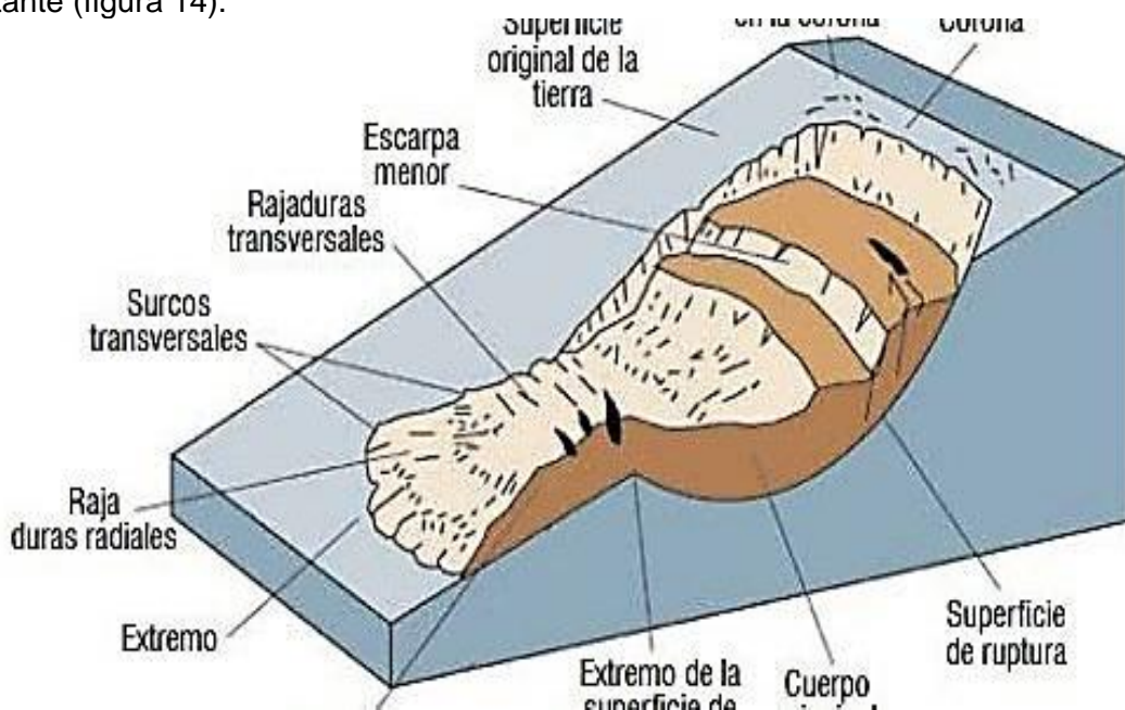
Figura 14. Deslizamiento de tipo rotacional, Adaptado de USGS (2008), GEMMA: PMA-GCA (2007).
