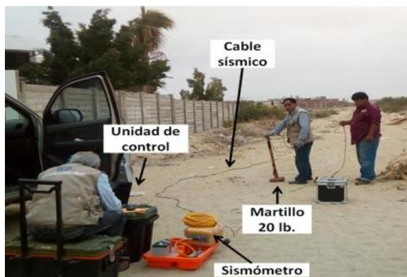
Figura 11: Equipo sísmico para la toma de datos con la técnica MASW en la Urb. Jardín.
