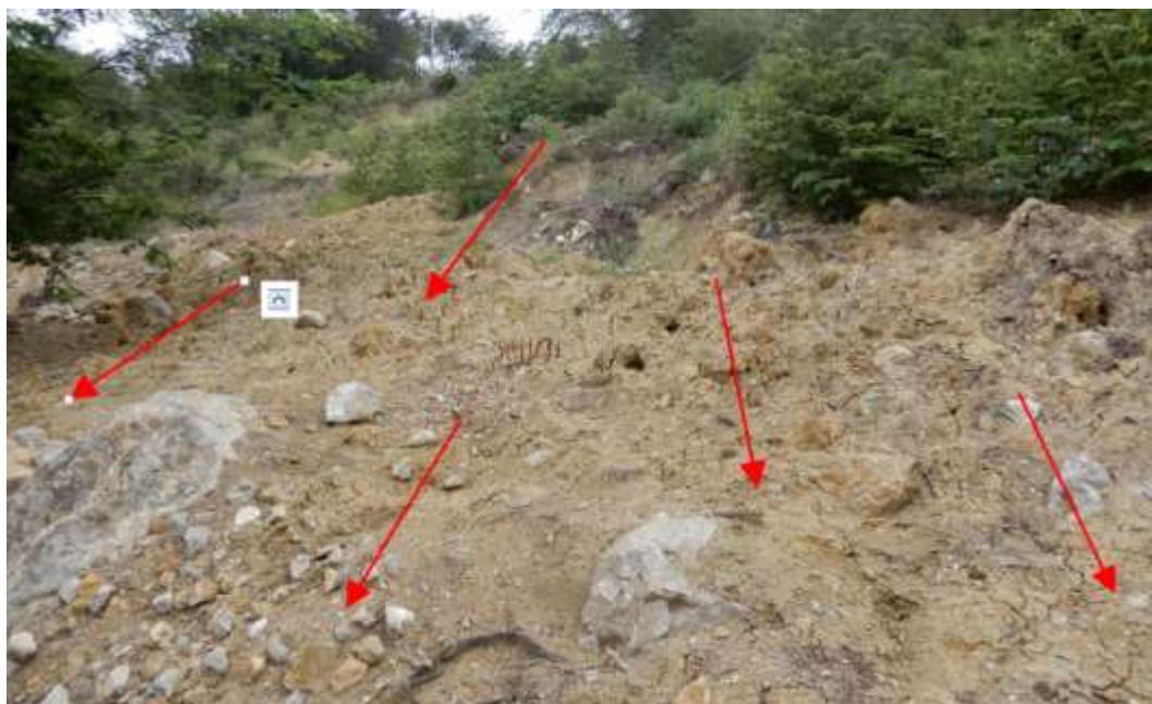
Figura 9. Material movilizado por el deslizamiento rotacional, se puede apreciar material limo arcilloso con presencia de clastos y bloques de caliza. Vista con dirección al nor oeste.
