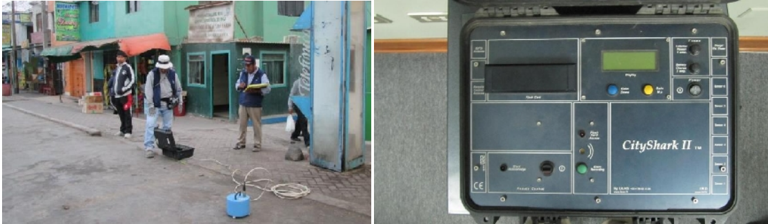
Figura 5: Equipo sísmico utilizado para el registro de vibraciones ambientales: sensores Lennartz (2N) y registrador CityShark
