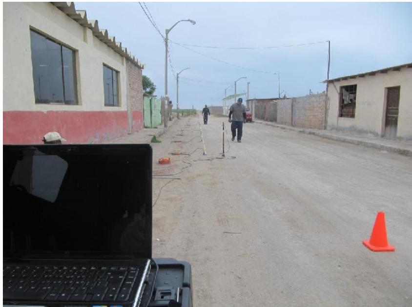
Figura 10: Ejemplo de la disposición del equipo de refracción sísmica en la ciudad de Punta de Bombón
