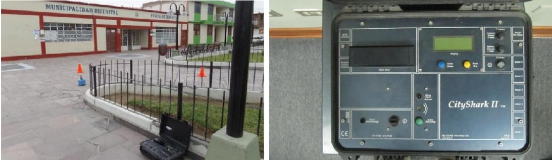
Figura 7: Equipo sísmico utilizado para el registro de vibraciones ambientales: sensores Lennartz (2N) y registrador CityShark
