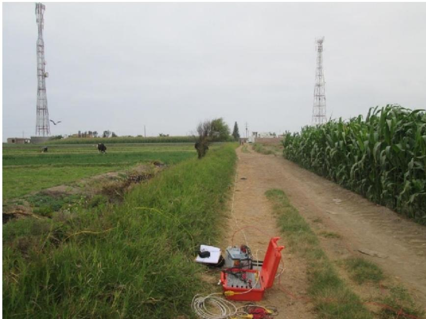
*Figura 11: Ejemplo de disposición del equipo de prospección eléctrica para la toma de datos en la ciudad de Punta de Bombón*
