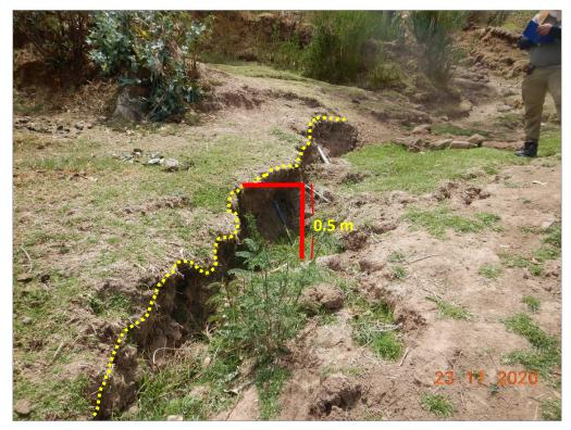
**Figura 9**. Desplazamientos de hasta 0.5 m en el terreno de la comunidad campesina de Huayllay, con coordenadas UTM (WGS 84): 817257 E, 8498224 N a 3633 m s.n.m.
