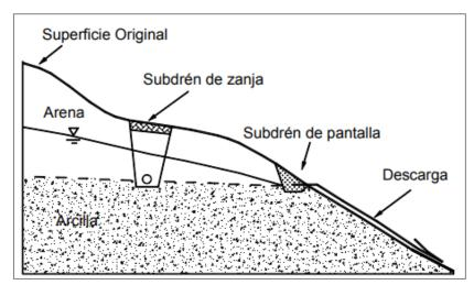
**Figura 16.** Esquema de un subdrenaje interceptor y un dren en el afloramiento (Suárez, 1998).
