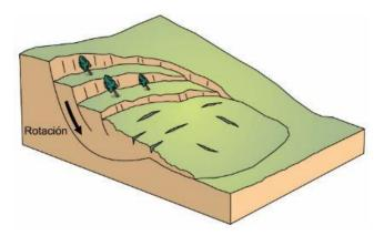
**Figura 13.** Esquema de un deslizamiento rotacional (tomado del Proyecto Multinacional Andino, 2007)
