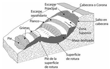
Figura 14. Partes de un deslizamiento rotacional. Fuente: Suarez J., 2009.
