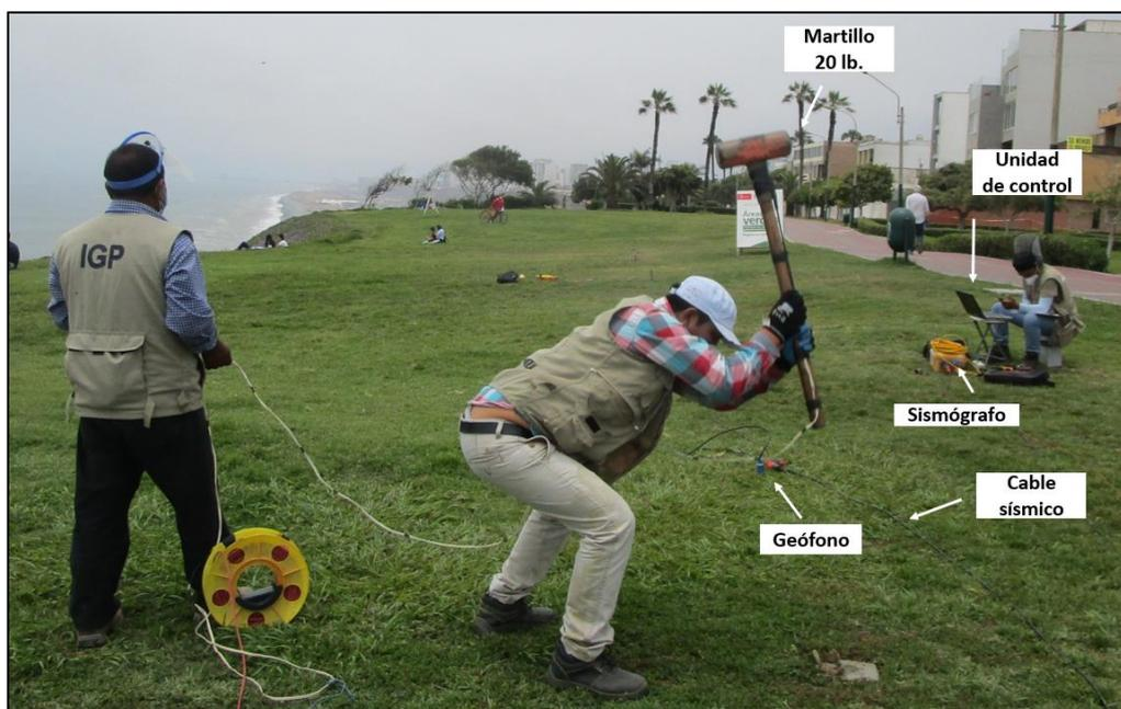
Figura 11. Equipos utilizados en la toma de datos por el método de MASW.
