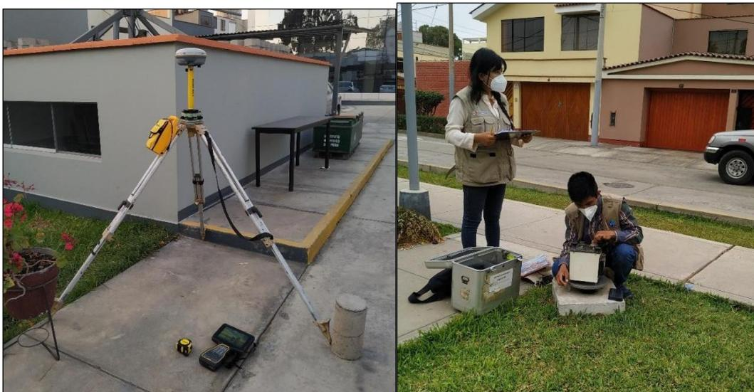
*Figura 35. Para la corrección de los datos tomados en San Isidro se consideró la estación gravimétrica base SAMI (distrito de San Miguel).*
