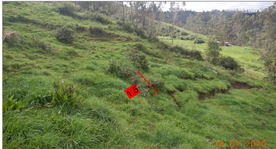
Figura 15. Se muestra escarpes en el cuerpo del deslizamiento con salto de 1.5m.
