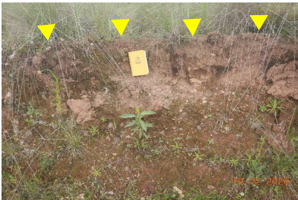
Figura 12. Escarpe de deslizamiento en proceso de reactivación, compuesta por arenas, arcillas de color rojizo.
