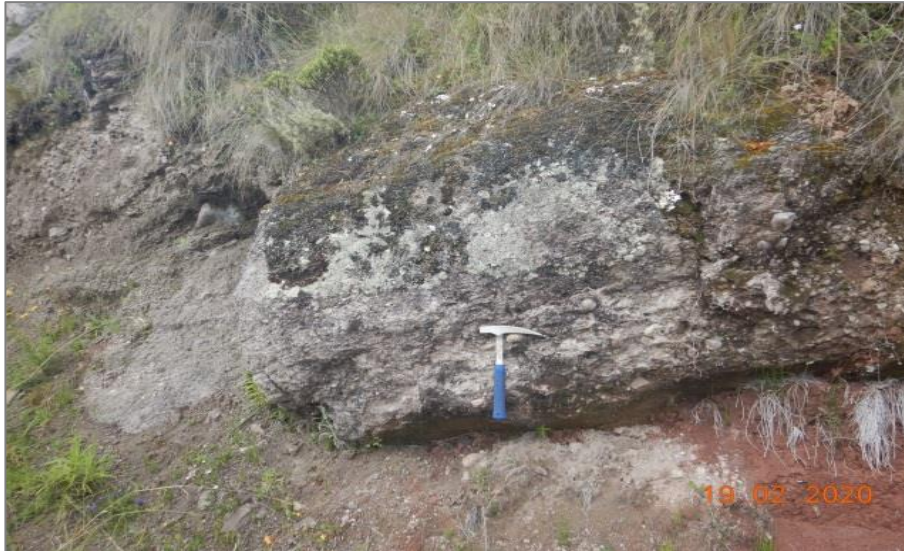
Fotografía 1. Afloramiento de conglomerado polimictico, de moderada a alta meteorización, compuestos por clastos de arenisca, intrusivos en matriz limo arenosa.
