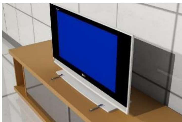
Figura 9.11 8. Formas de asegurar equipos electrónicos, mediante seguros de correas
