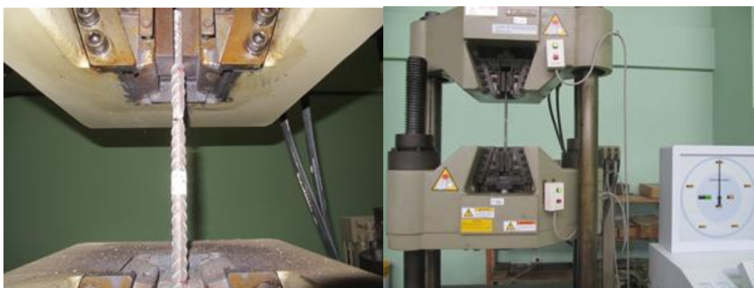
Figura AIII-3. Ensayes a tracción de las muestras de acero.
