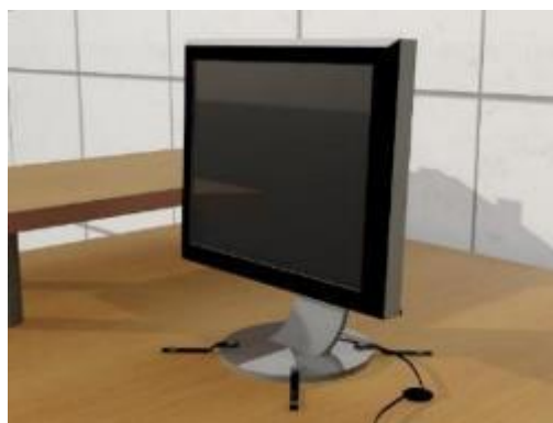
Figura 9 3 Monitor fijado con correas al mueble de escritorio.
