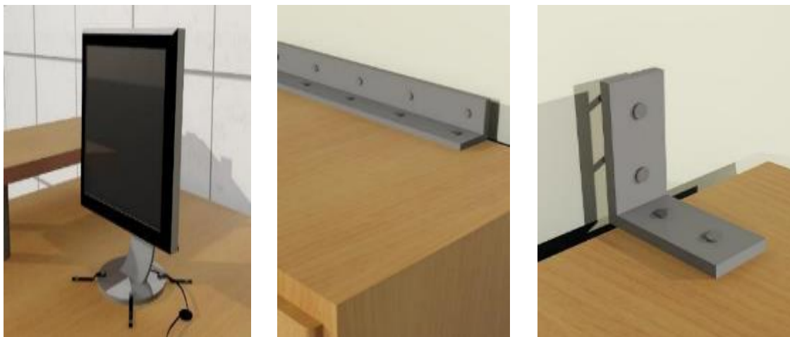
Figura 9.10 7. Los sistemas de aseguración pueden ser de diferentes tipos, en las zonas laterales o parte superior, el objetivo es contar con puntos de sujeción ante volcamientos o caídas
