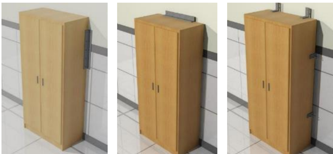
Figura 9.5 6. Muebles y armarios deben estar fijados y asegurados afín de evitar caídas que afecten al personal de salud o que obstruyan salidas o corredores de evacuación.
