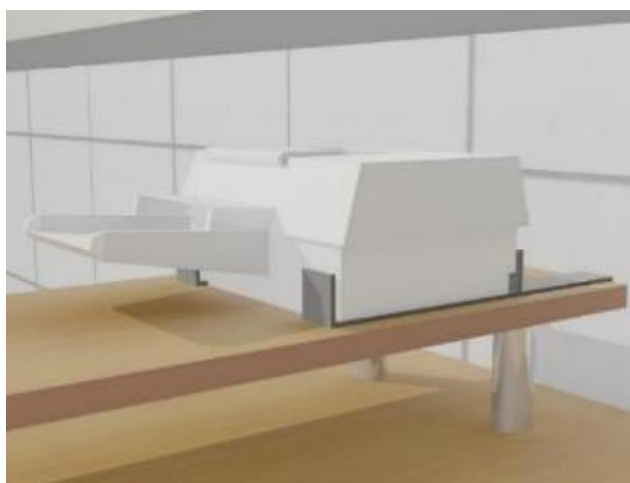
Figura 9.4 Equipos como impresoras deben estar sujetos o asegurados para evitar su desplazamiento
