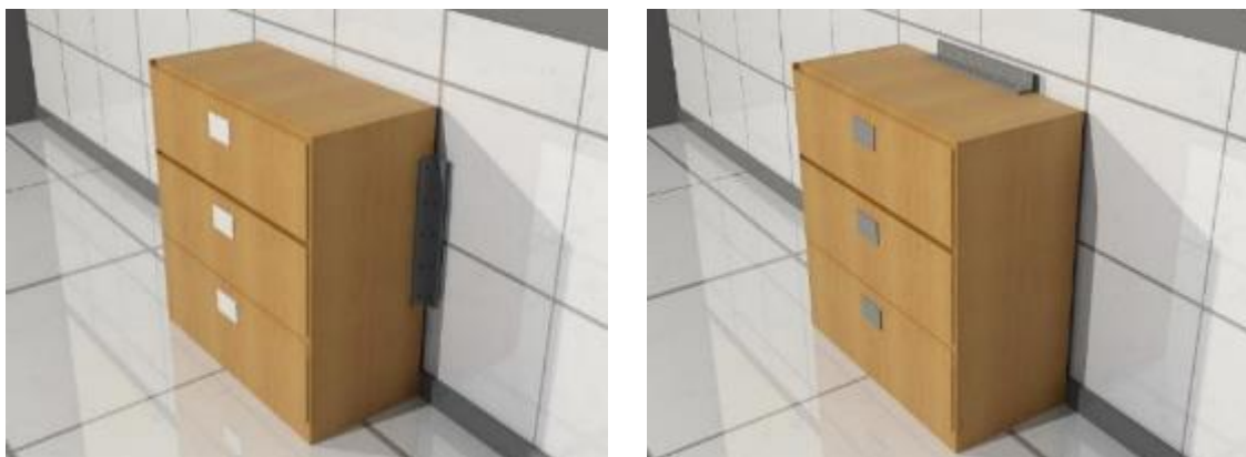
Figura 9.4 5. Archivadores deben estar asegurados y evitar caídas que obstruyan salidas o corredores de evacuación.
