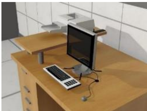
Figura 9 3 Monitor fijado con correas al mueble de escritorio.
