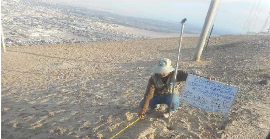
Figura 27: Ejemplo de ensayo con posteadora manual, posteo 05 en el área del mirador de Alto de la Alianza.
