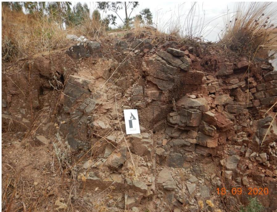
**Fotografía 1.** Vista al SO de Poroy, areniscas fuertemente fracturadas y medianamente meteorizadas de la Formación Ausangate.
