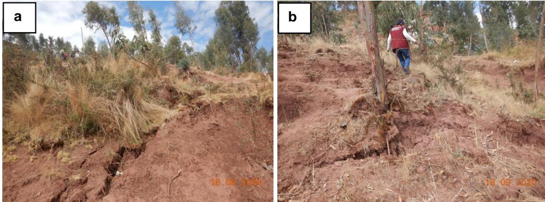
**Figura 8.** a) Asentamiento del terreno, con 55 cm de desplazamiento. b) Árboles inclinados a favor de la pendiente y removidos desde su raíz.
