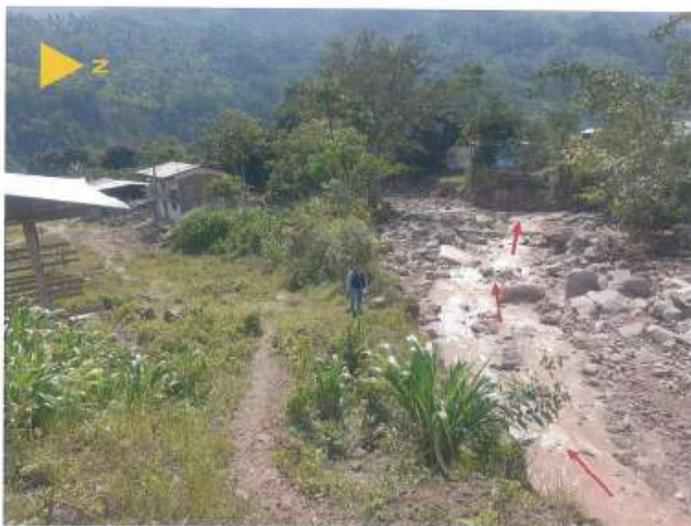
Foto 02: Cauce aluvial de la quebrada San Nicolás (flechas rojas), cuyas aguas fluyen en dirección predominante este-oeste y a través del cual se generan flujos de detritos.
