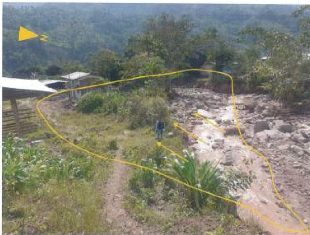
Foto 07: Esquema de abanico aluvial antiguo formado por la ocurrencia de flujos de detritos antiguos, sobre esta unidad geomorfológica se ubica la mayor parte del área urbana del poblado Alto Perú.
