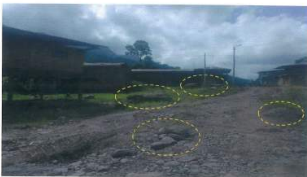
Foto 10: Evidencia de materiales heterogéneos (gravas, bloques de rocas en matriz limo - arcillosa) que conforman los depósitos aluvionales (polígono amarillo)
