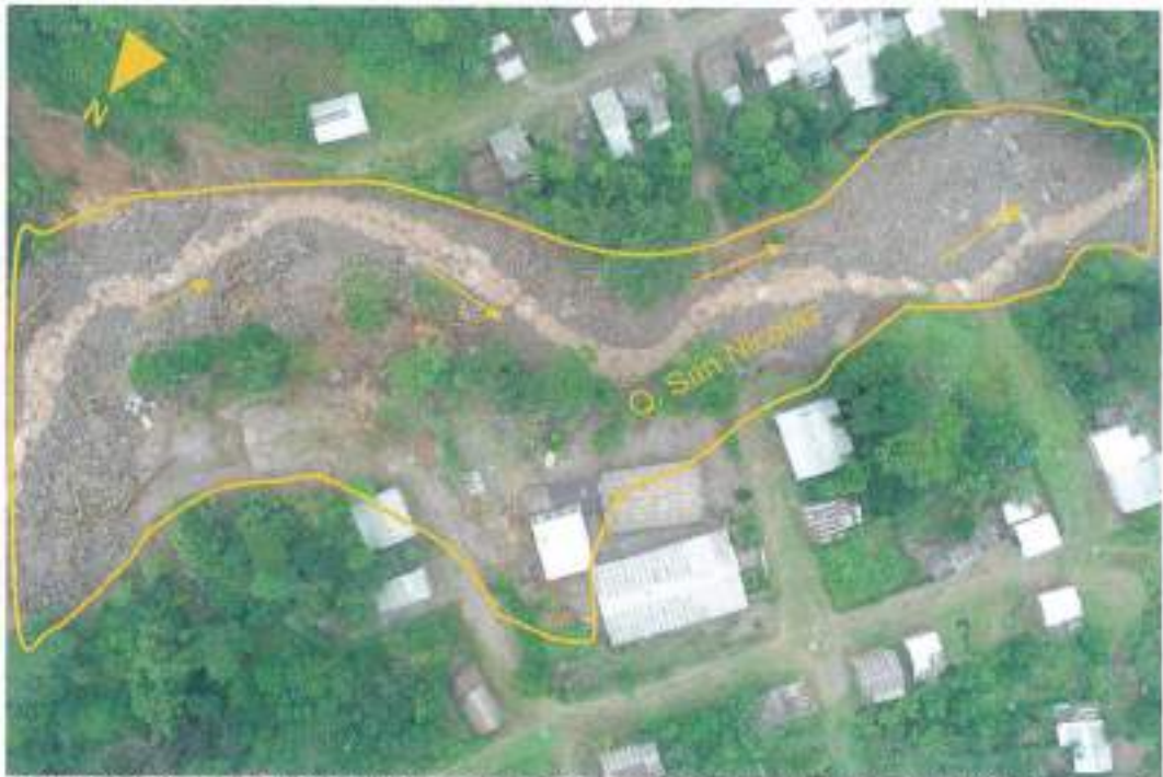
Foto 18: Flujos de detritos desplazados por el cauce de la quebrada San Nicolás y por el área urbana del poblado Alto Perú asentada en zonas de baja pendiente
