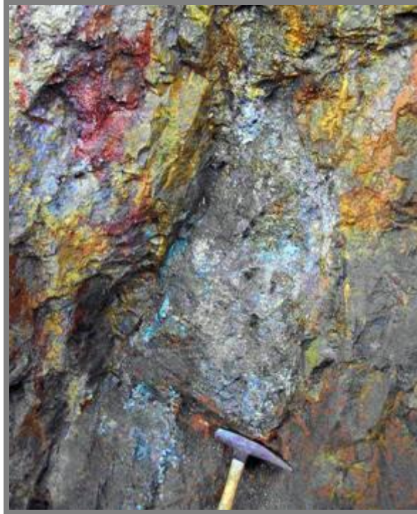
Foto N° 37: Detalle de los diques y stockworks con cpy py
