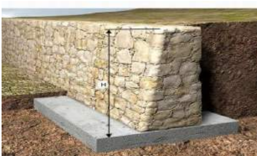
Ilustración 1. Muro de contención con bloques rígidos
