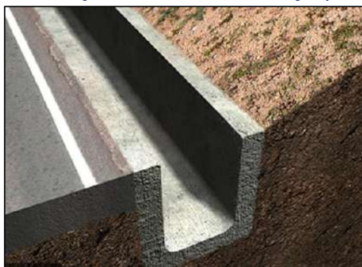
Imagen N° 14: Canal de Evacuación de aguas pluviales
