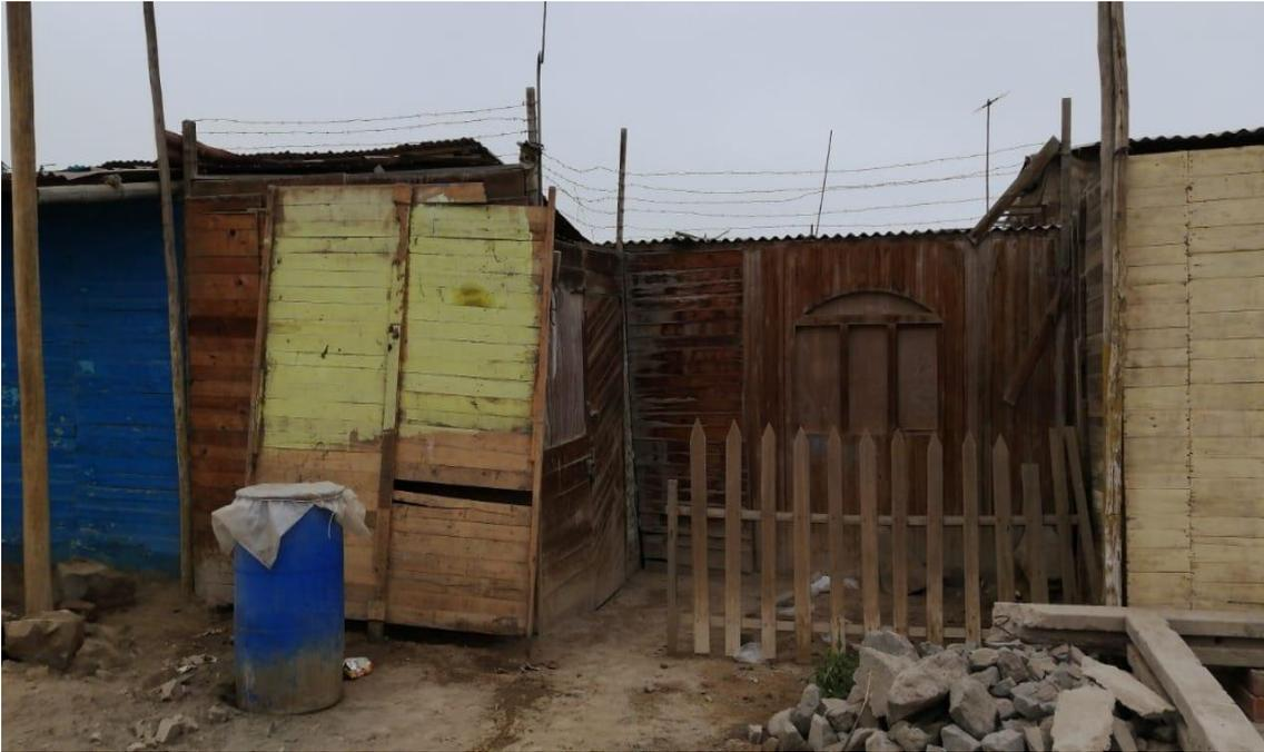
FOTOGRAFÍA N° 11. Mz. U, lote 6, vivienda de material de madera, no cuenta con cemento y se encuentra en malas condiciones.
