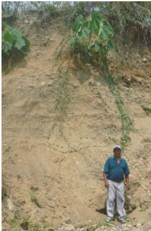
Figura N°2.- Se aprecian secuencias de gravas englobadas en una matriz arenosa, y algunos niveles de lentes de arenas, no compactos.
