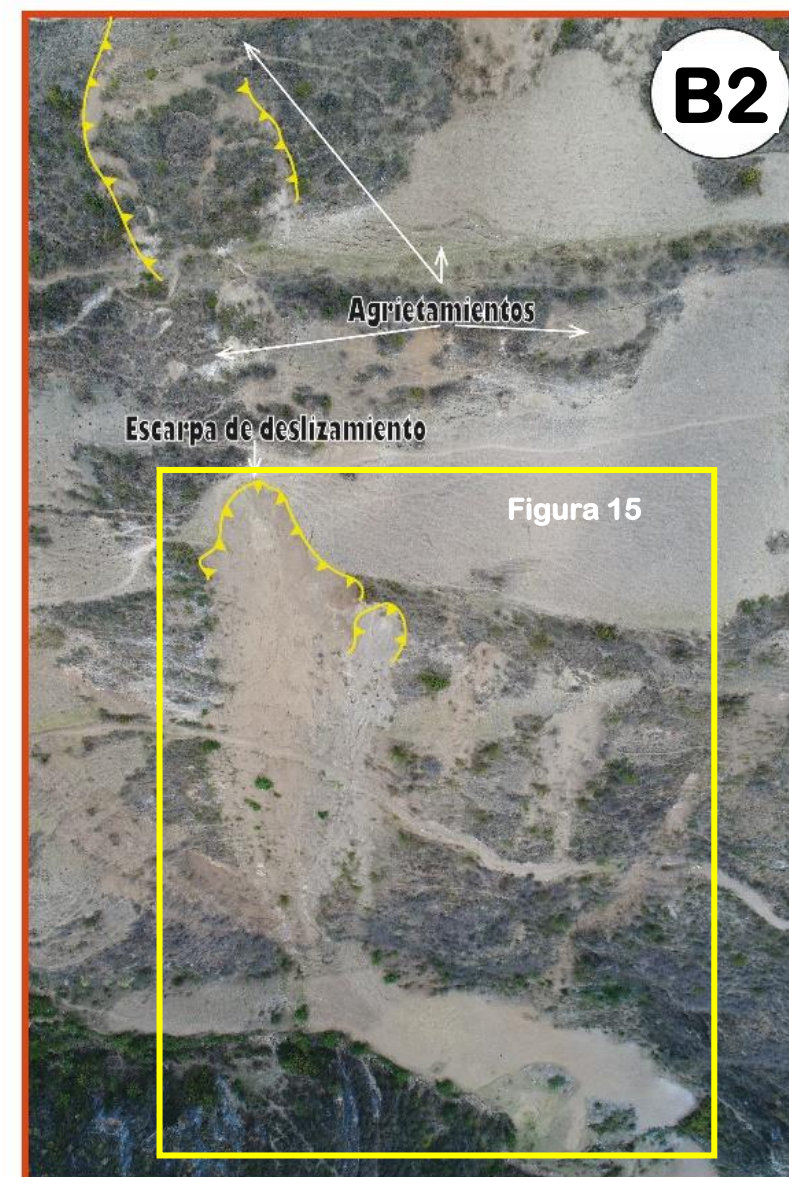
Figura 16: A. Cartografiado del estado actual del sector 1 del área de estudio. B. Vistas de la parte alta (B1), media y baja (B2) del área activo de deslizamiento
