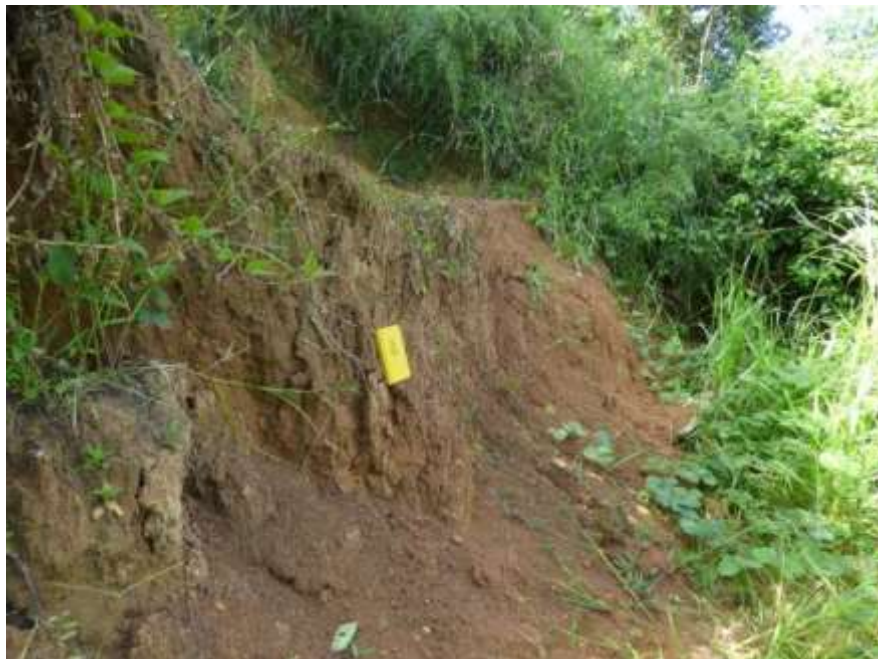
Fotografía 2. Depósitos aluviales constituidos por gravas polimícticas poco consolidadas de tamaño heterogéneo envueltos en matriz limo-arcillosa. Vista al noreste
