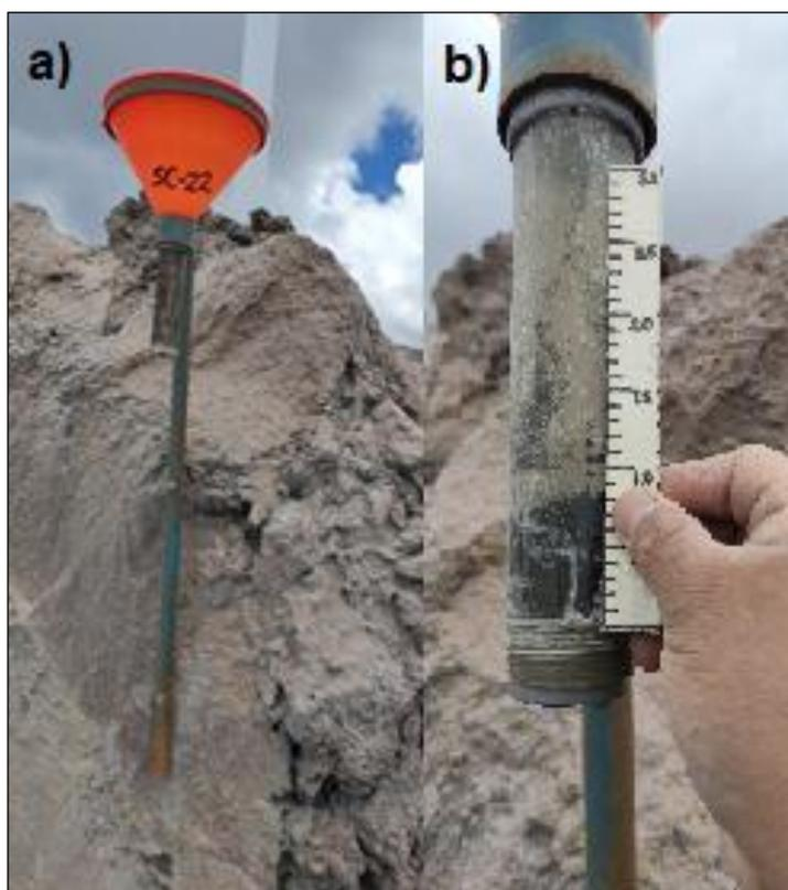
**Figura 6:** a) Cenizómetro SC-22 estación Sab11, b) Medición de espesor de ceniza cenizómetro SC-22.
