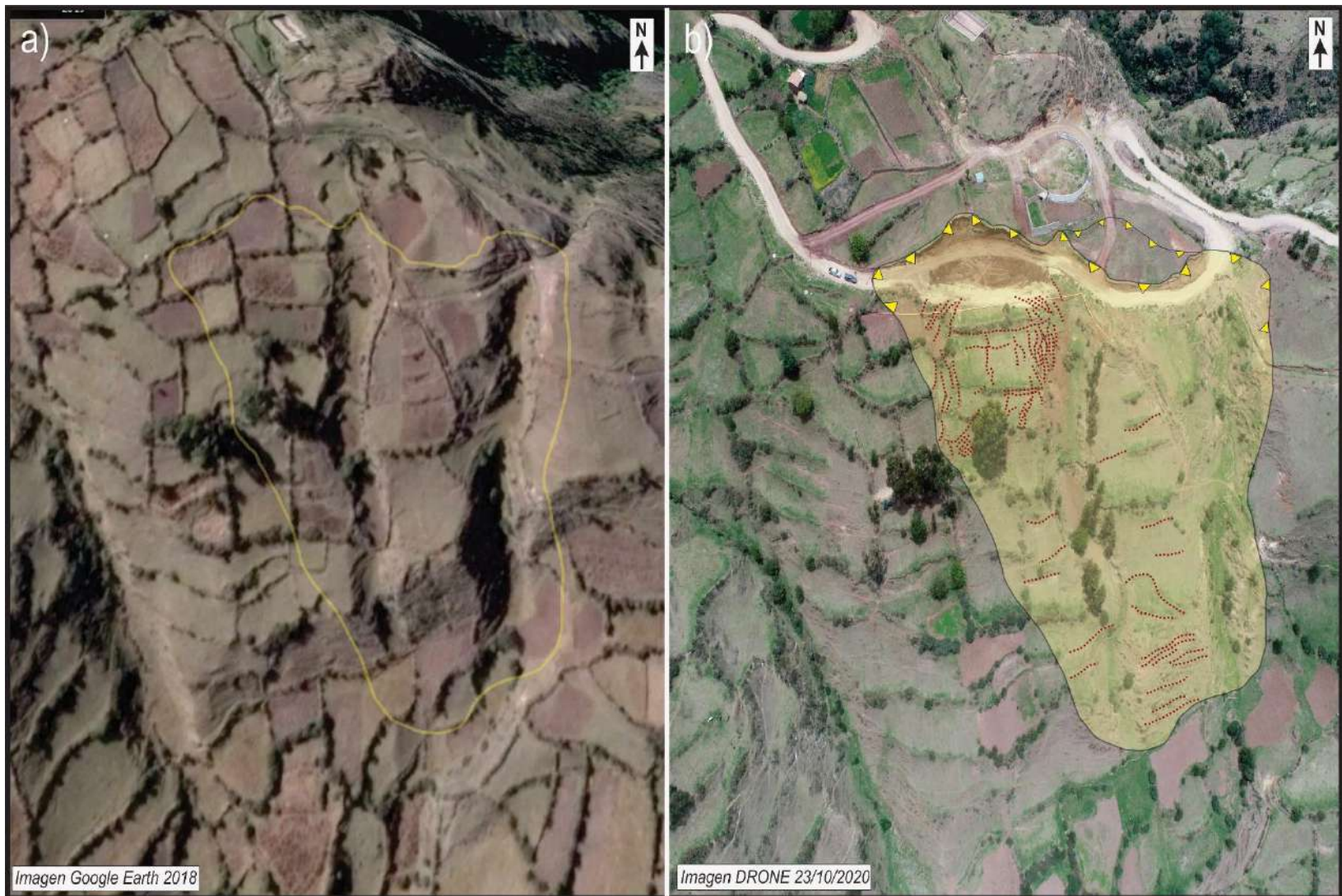
Figura 13. Vista donde se observa: a) imagen satelital del Google Earth del año 2018, b) imagen tomada con el Drone, a 13 días de la generación de del deslizamiento rotación del centro poblado de Tiaparo.
