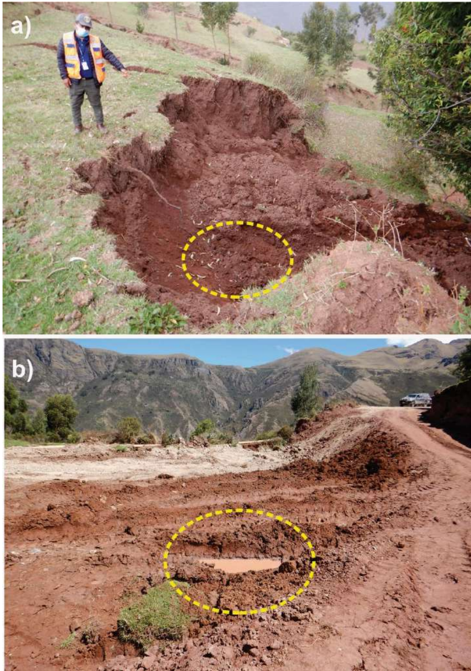
Figura 12. Vista donde se observa: a) ojo de agua en parte del material depositado del deslizamiento (línea amarilla), b) se observa agua empozada a 4 m de la vía (línea amarilla), ubicadas entre las coordenadas UTM a) 8431584 N, 705242 E y b) 8431539 N, 705262 E con una altitud de 3606 m s.n.m
