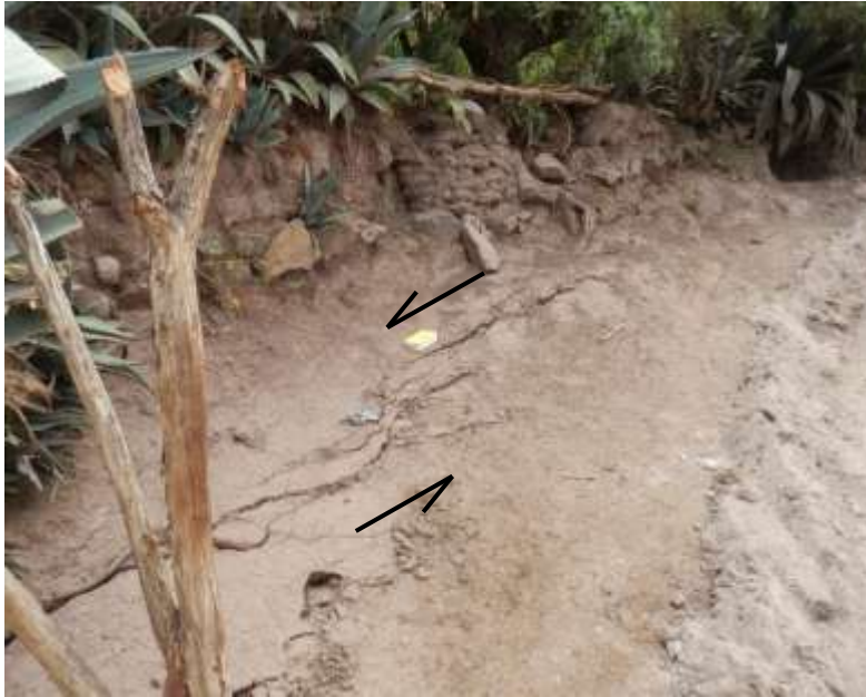
Foto 7: Grieta en el poblado de Miskas, tiene una longitud de 15m con dirección preferente N110°, la abertura máxima es de 7 cm, se observa un tipo de movimiento sinistral.
