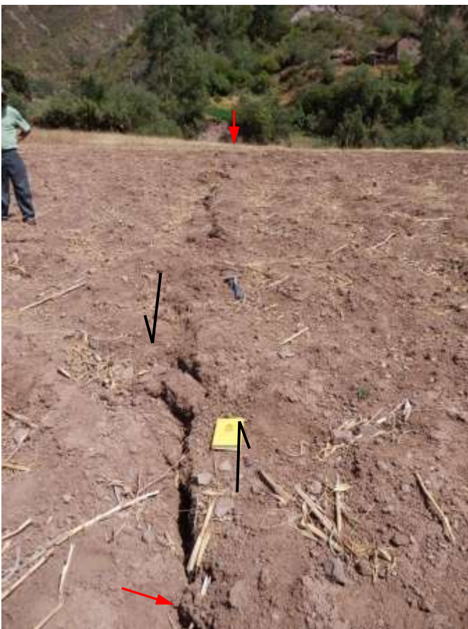
Foto 9: Grieta en el poblado Cusibamba Bajo, tiene una longitud de 25m y afecta la carretera, la dirección principal es N112° y su abertura máxima con 10cm, se observa como las grietas estas en dirección de una vivienda destruida
