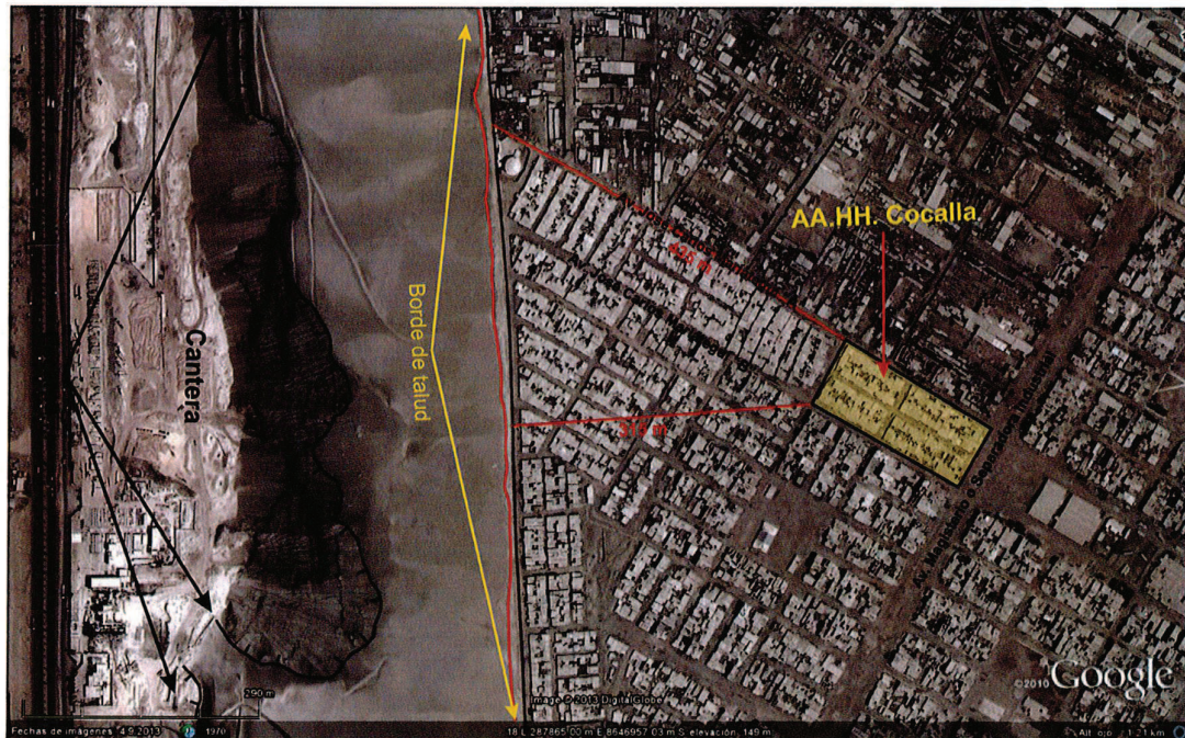
Figura 5.- Se muestra las escarpas formadas por la extracción de material.
