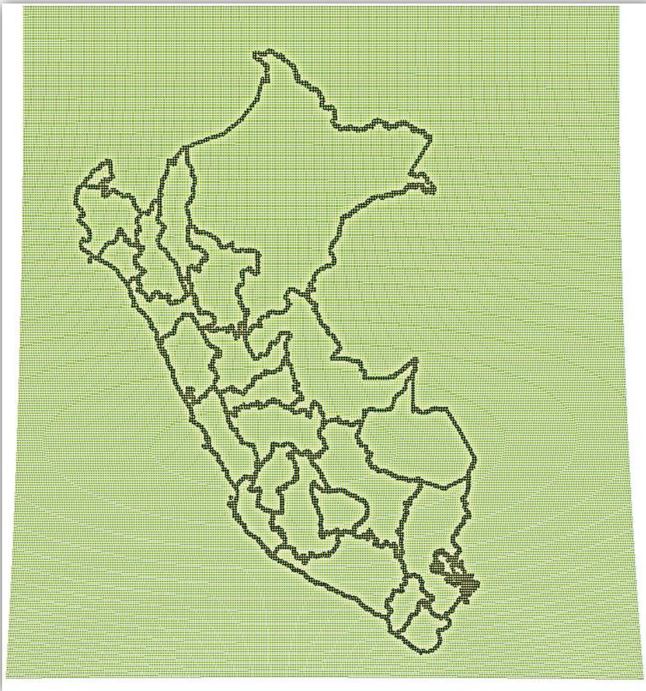
**Figura 10:** Resultado de la formación de grilla regular para imágenes GOES, cada celda tiene una separación de 4\*4Km la grilla obtenida ya es reducida para el área de trabajo que deseamos realizar, toda la región Perú.
