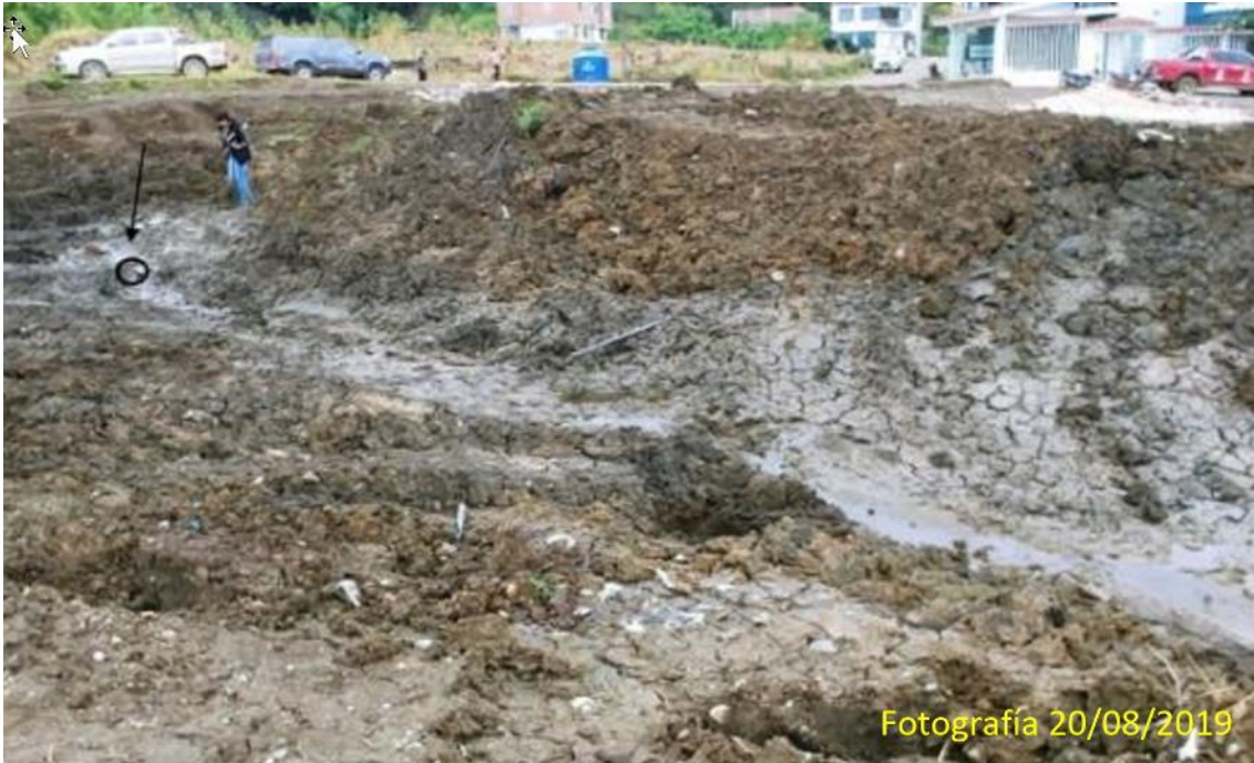
Figura 8: Surgencia de agua subterránea en el contacto entre suelo orgánico y suelos arcillosos de coloración grisácea.
