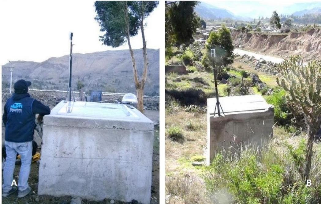
**Figura 37:** Ejemplo de estaciones permanentes con sistemas de transmisión de datos en tiempo real usados en por ejemplo el deslizamiento de Maca (Caylloma – Arequipa)
