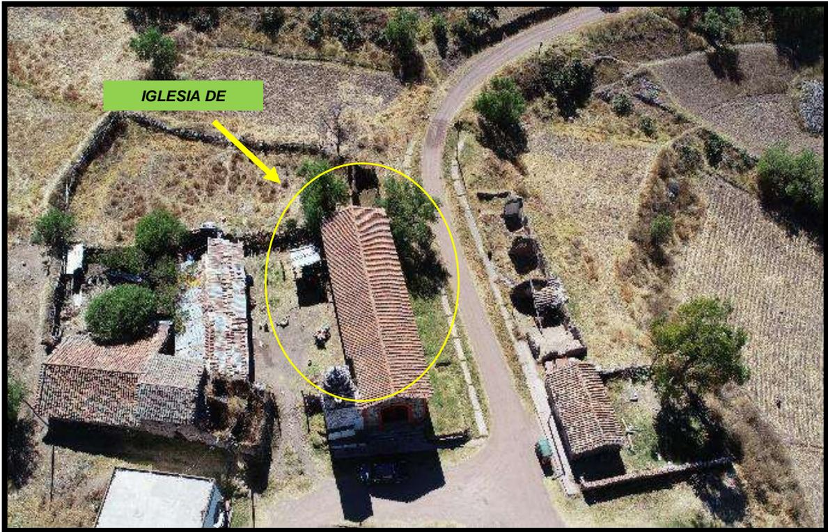
**Imagen N° 15:** Evidencia el Hundimiento y deformación de la Iglesia de la comunidad de Chincho..
