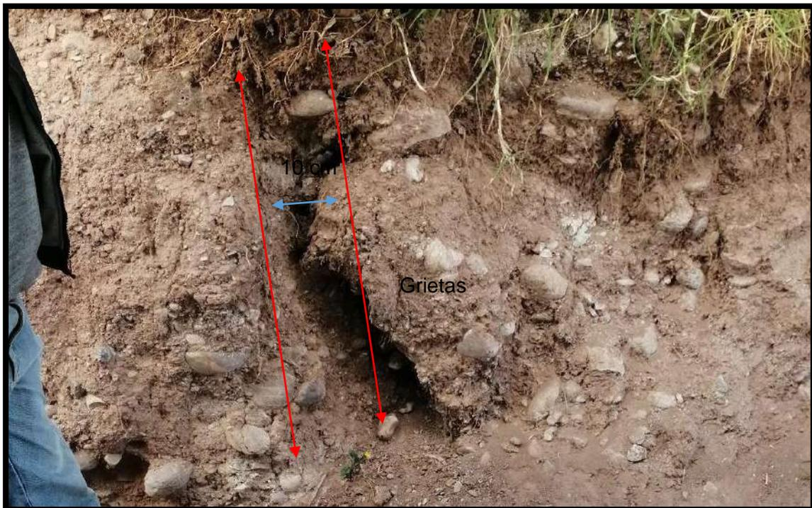
**Imagen N° 20:** Vista de grietas con aberturas de entre 10 cm, por la ocurrencia del deslizamiento en temporadas de lluvias y la posterior sobresaturación de suelos.
