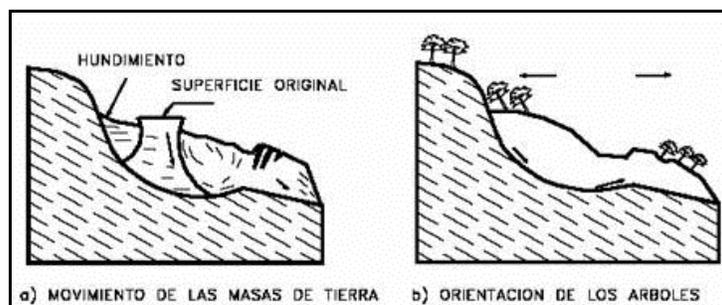
Figura 05. Deslizamiento rotacional típico.
