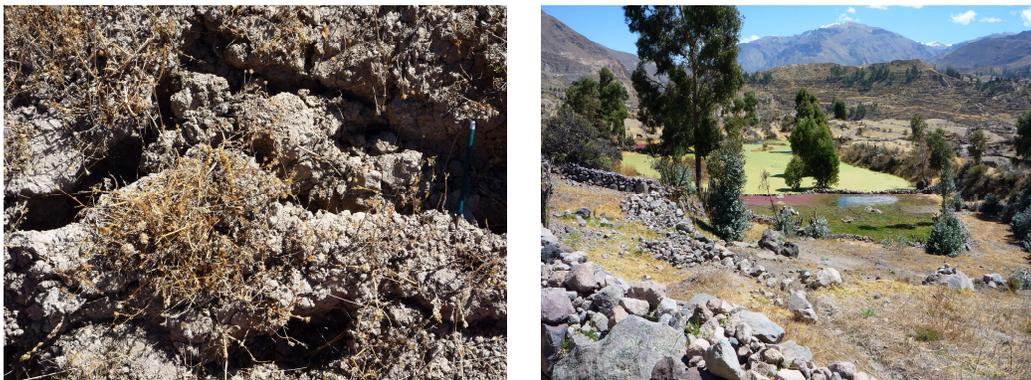
**Figura 11. Fotografías tomadas de las grietas de distensión y oconales en el deslizamiento de Maca.**
