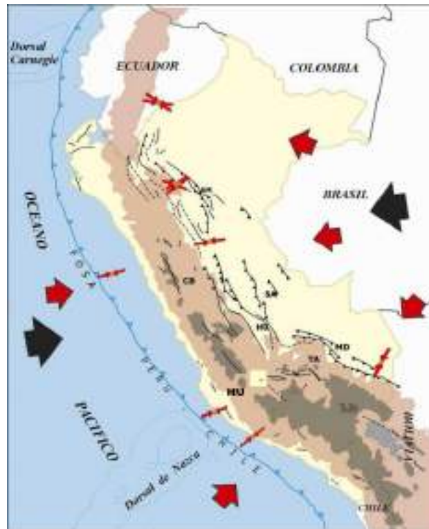
Figura N° 5. Esquema sismotectónico en superficie y distribución de los principales sistemas de fallas geológicas en Perú
