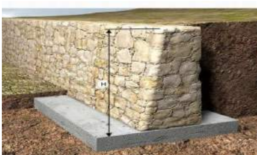
Ilustración 3. Muro de contención con bloques rígidos
