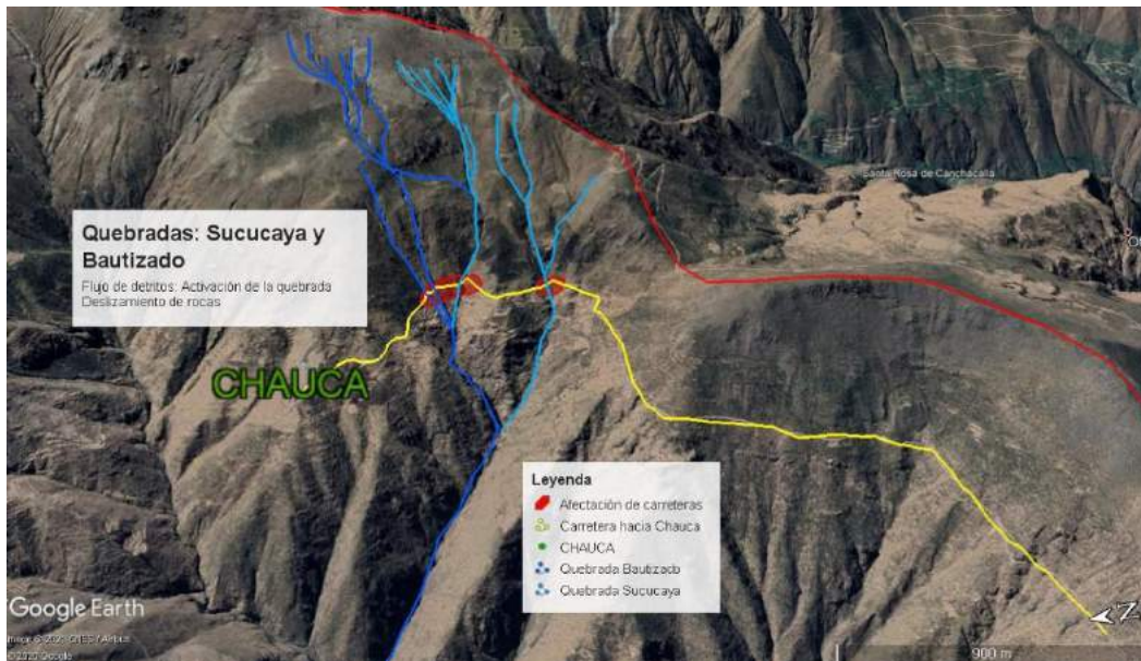
Imagen N° 22: Deslizamiento de suelo y roca, y activación de las quebradas Sucucaya Y Bautizado.
