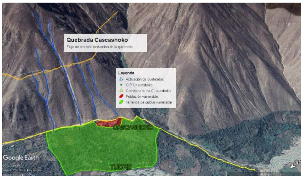
Imagen N° 24: Huaycos por la activación de la quebrada Cascashoko
