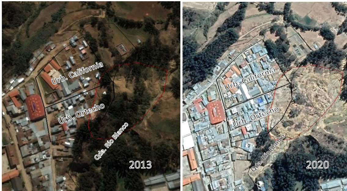
Figura 15. Análisis multitemporal realizado en las urbanizaciones Ortecho y California del sector de Tayabamba, las cuales fueron afectadas el 15 de marzo del 2020 por un deslizamiento.
