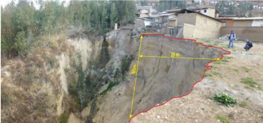
Figura 14. Se muestra las dimensiones del avance del carcavamiento, en la margen izquierda de la quebrada Río Blanco.
