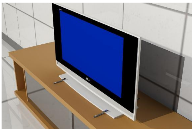
Figura 73. Formas de asegurar equipos electrónicos, mediante seguros de correas
