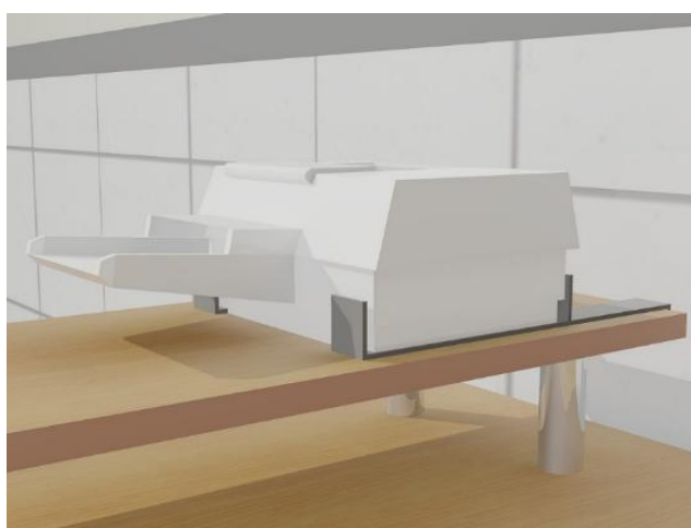
Figura 69. Equipos como impresoras deben estar sujetos a asegurados para evitar su desplazamiento ante
