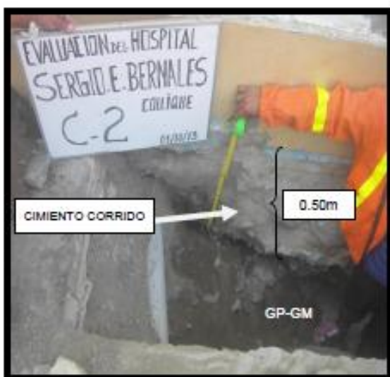
FOTO N° 6 VISTA DE LA AUSCULTACION POR MEDIO DE CALICATA DE LA CIMENTACION, DONDE SE OBSERVA LA PROFUNDIDAD DE LA CIMENTACION Y LOS MATERIALES EXISTENTES DEBAJO DEL CIMENTO.
