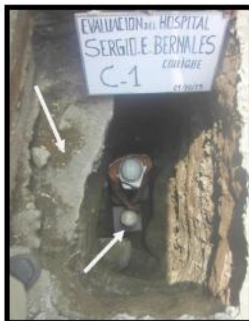
FOTO N° 4 VISTA DEL CIMIENTO DONDE SE OBSERVA FALSA ZAPATA Y EL ENSAYO DE DENSIDAD NATURAL EN EL FONDO DE LA CALICATA
