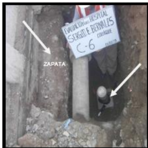
FOTO N° 14 VISTA DE LA AUSCULTACION DONDE SE OBSERVA LA ZAPATA Y EL ENSAYO DE DENSIDAD NATURAL METODO CONO DE ARENA
