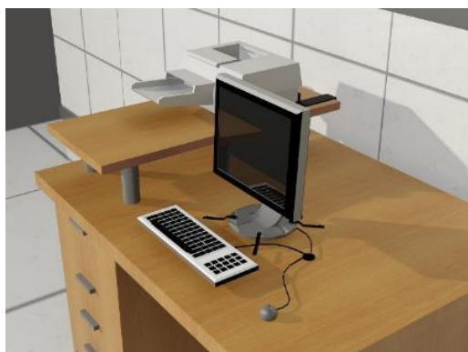
Figura 68. Monitor fijado con correas al mueble de escritorio y evitar su caídas ante movimientos sísmicos
