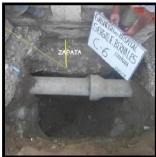
FOTO N° 14 VISTA DE LA AUSCULTACION DONDE SE OBSERVA LA ZAPATA Y EL ENSAYO DE DENSIDAD NATURAL METODO CONO DE ARENA
