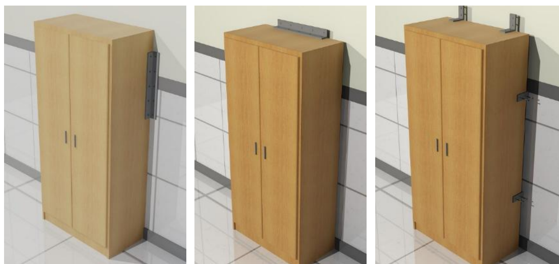
Figura 71. Muebles y armarios deben estar fijados y asegurados afín de evitar caídas que afecten al personal de salud o que obstruyan salidas o corredores de evacuación. .
