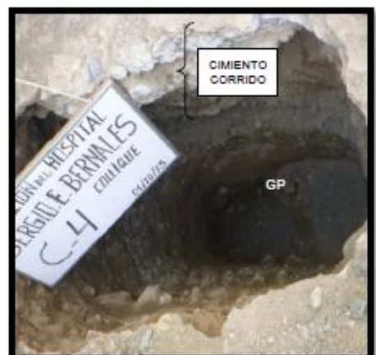
FOTO N° 10 VISTA DEL CIMENTO CORRIDO Y EL MATERIAL.
