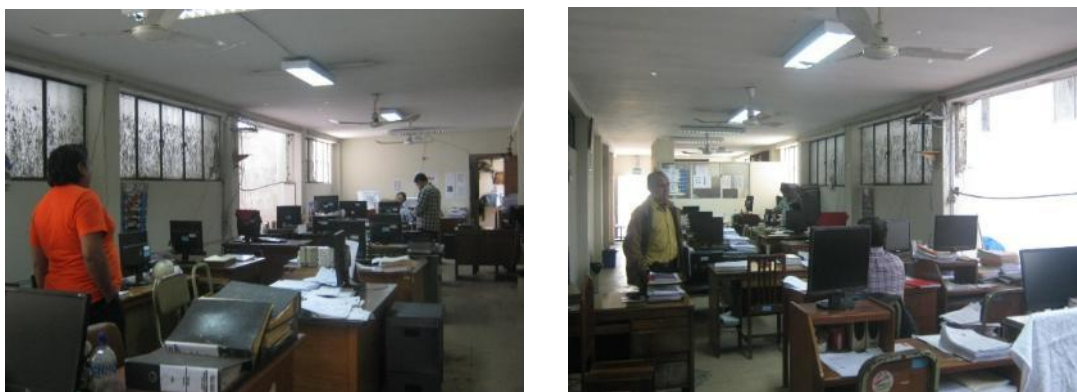
Figura 31. En la mayoría de los casos, las computadoras, monitores e impresoras no están asegurados a los muebles, estos se encuentran únicamente colocados encima de los muebles de cómputo, asimismo, estos muebles son tipo escritorio y no tienen sistema de ruedas ni frenos.
