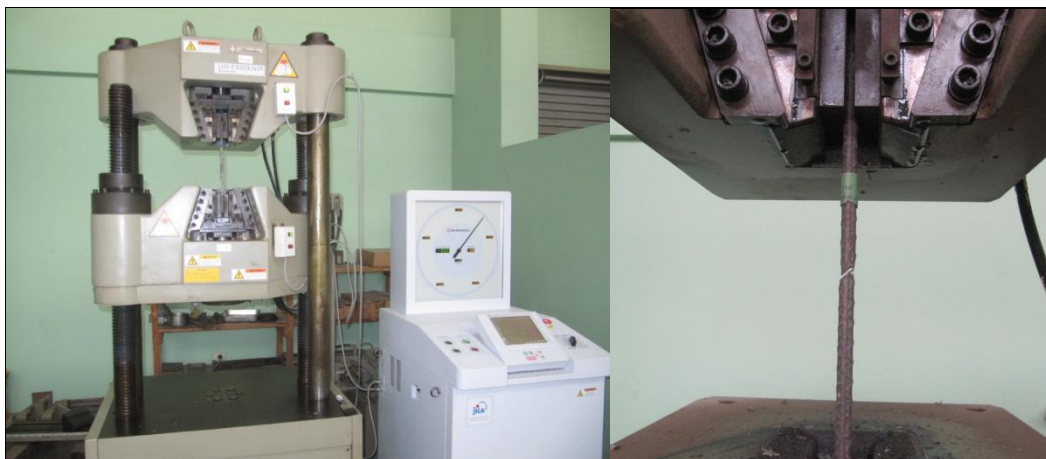
Foto 5. Ensayo de tracción de muestras de acero
