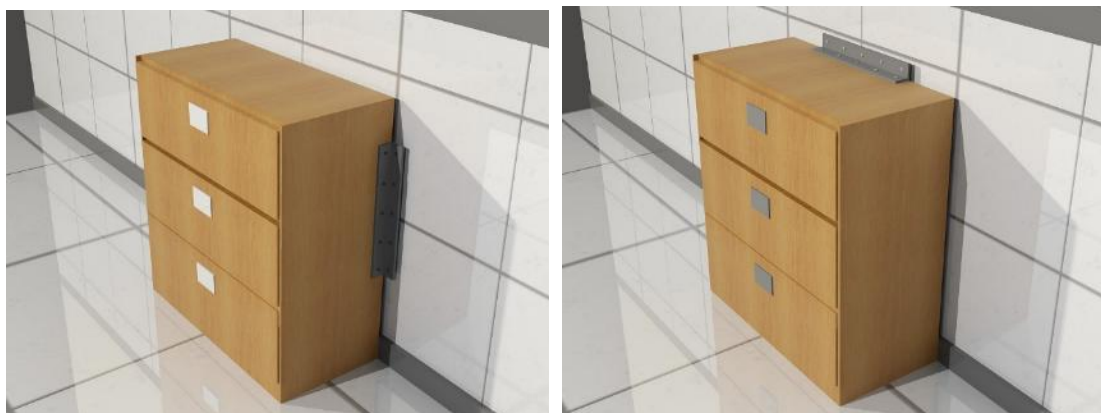
Figura 70. Archiveros deben estar asegurados y evitar caídas que obstruyan salidas o corredores de evacuación. .
