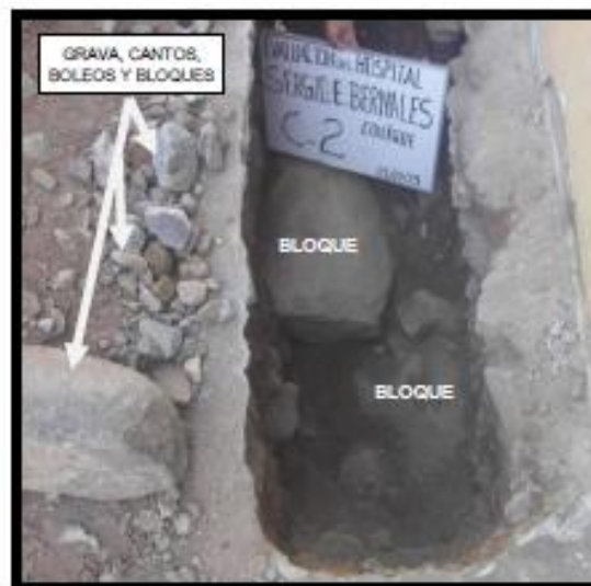
FOTO N° 6 VISTA DE LA AUSCULTACION POR MEDIO DE CALICATA DE LA CIMENTACION, DONDE SE OBSERVA LA PROFUNDIDAD DE LA CIMENTACION Y LOS MATERIALES EXISTENTES DEBAJO DEL CIMENTO.
