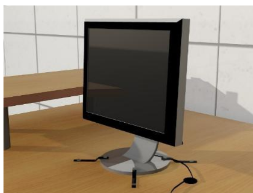
Figura 68. Monitor fijado con correas al mueble de escritorio y evitar su caídas ante movimientos sísmicos
