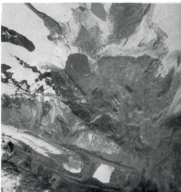
Foto 3. Del SAN tomada el 23/6/66. Comparando esta fotografía con las anteriores, vemos que se han producido notables cambios: a) La laguna de Safuna Baja (29) ha aumentado su nivel, lo cual está demostrado por la desaparición bajo las aguas de una pequeña punta que se notaba en 1950 y 1962.
