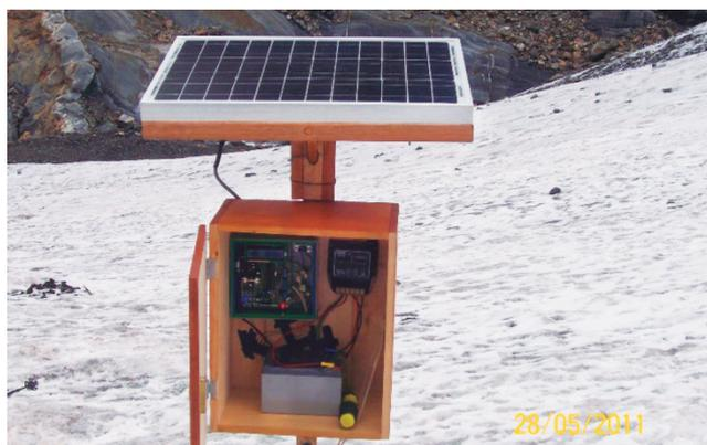
Figura 2. Equipo de datalogger con panel solar operativo.
