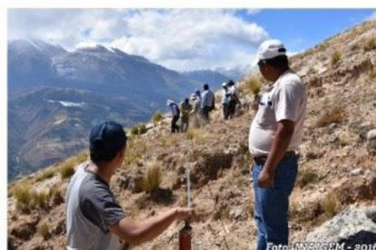
Medición del perfil extensométrico en la parte alta del deslizamiento
