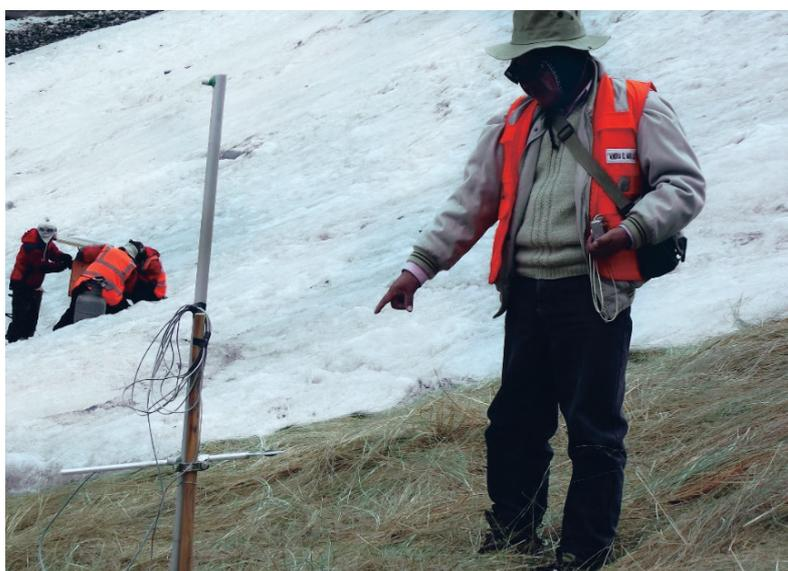
Figura 3. Microtorre de termistores ensamblado (a la izquierda), micro torre instalada en la superficie de Tratamiento, con ichu (al centro) y en la superficie testigo, glaciar descubierto (a la derecha)
