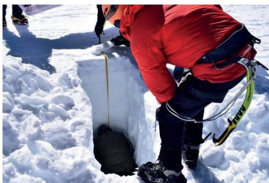
El pozo de acumulación se excavó hasta 1.69 m de profundidad. Se observó un perfil homogéneo en la acumulación de nieve
