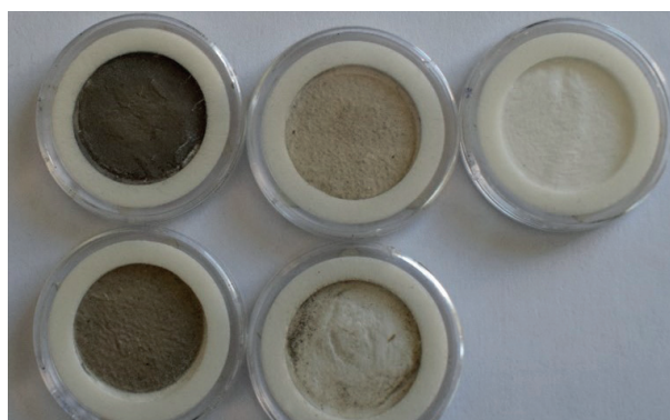
Filtros con Carbono Negro obtenidos a partir del filtrado de las muestras líquidas
