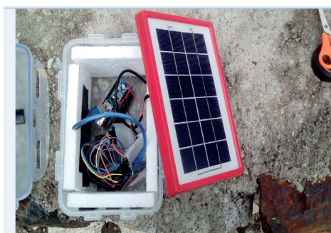
Figura 14. A la izquierda se observa la estructura del proyecto junto al panel solar. A la derecha se tiene una vista del sensor que será ubicado en una línea paralela sobre el espejo de agua y medirá la altura
