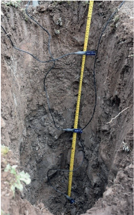
Foto 6. Sensores de humedad del suelo a 40cm, 60 cm y 1m
