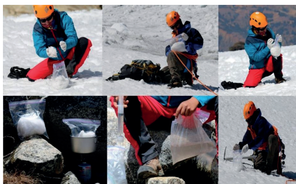
Toma de muestras de nieve y procedimiento de fusión y filtrado de muestras
