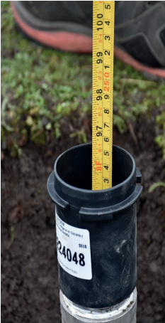
Foto 8. Profundidad del piezómetro
