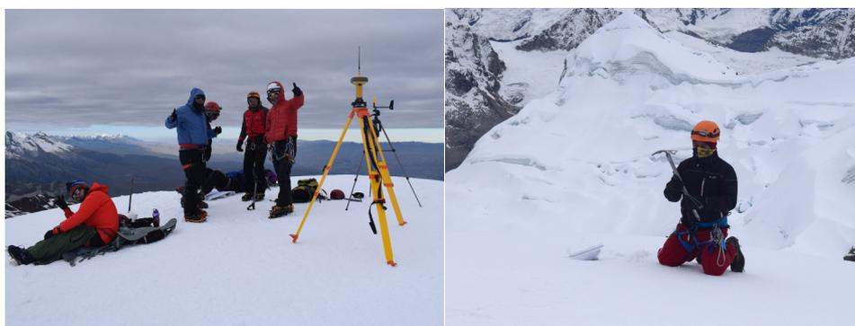
Fotos 1 y 2. Ubicación de los sensores de navegación satelital base (Huanchac) y rover (Vallunaraju)
