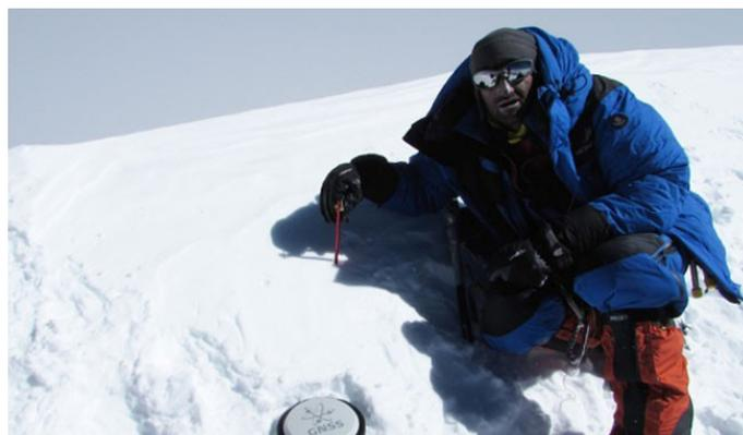
Foto 3. Expedicionario de la misión "K2, 60 años después" (2014), midiendo las coordenadas y elevación del K2 con un GPS diferencial
