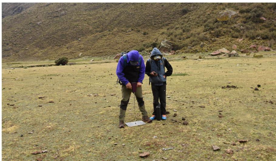
*Figura 4. Medición de compactación del suelo*
