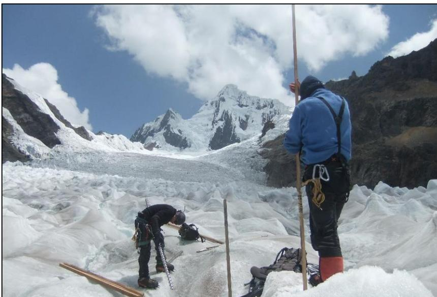
Fotografía N° 3: Personal técnico realizando instalación de balizas en la zona de ablación.
