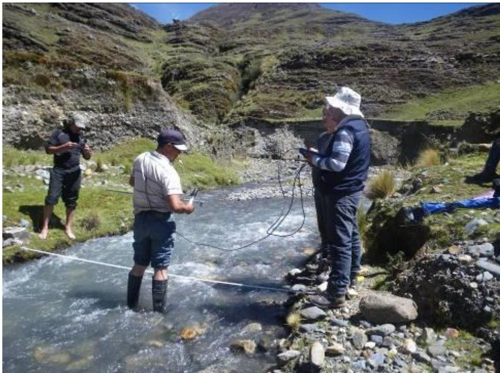
El personal realizando aforo en la parte baja de la quebrada Yantaqueña
