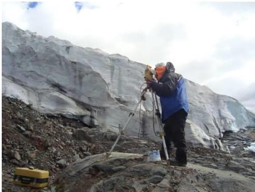
Personal realizando levantamiento topográfico de la lengua glaciar Huillca
