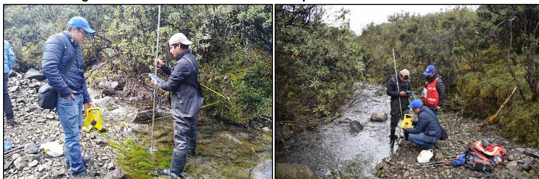
Fotografía N.º 15: Estimación de Caudales por el Método del Correntómetro
